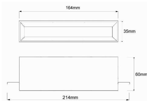
**1** Fazer um corte no forro de gesso cartonado para instalação da luminária.
