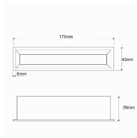
**1** Fazer um corte no forro de gesso cartonado para instalação da luminária. Considerar a medida de 168mm x 38mm para o corte.
