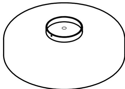
**01.** Fazer as ligações elétricas e parafusar a contra canopla no teto/parede com bucha e parafuso.
