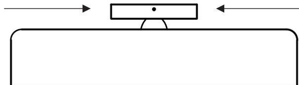
**02.** Entre com a luminária e faça a fixação da luminária na canopla através de 2 parafusos laterais.
