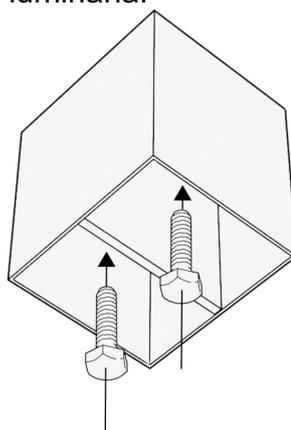
Aparafuse a luminária no teto utilizando os furos centrais
