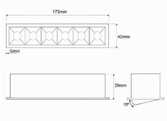
**1** Fazer um corte no forro de gesso cartonado para instalação da luminária. Considerar a medida de 168mm x 38mm para o corte.
