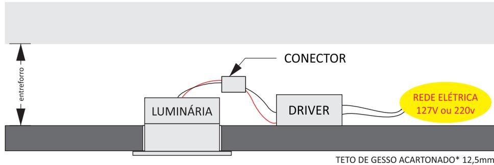
Faça instalações elétricas e conexões, deixando o driver no forro.
