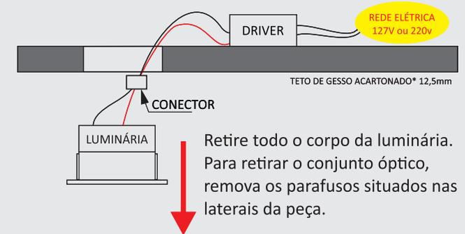
Retire todo o corpo da luminária. Para retirar o conjunto óptico, remova os parafusos situados nas laterais da peça.
