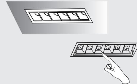
**6** Para manutenção: Retire todo o corpo da luminária. Destacando-o do forro de gesso .
