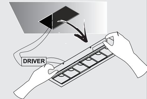
Para retirar o conjunto óptico, remova os parafusos situados nas laterais da peça.
