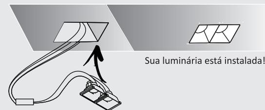
**7** Em caso de manutenção: Pressione uma das extremidades para que, em movimento de gangorra, o miolo saia da luminária possibilitando assim o acesso ao driver ou substituição do conjunto óptico.
