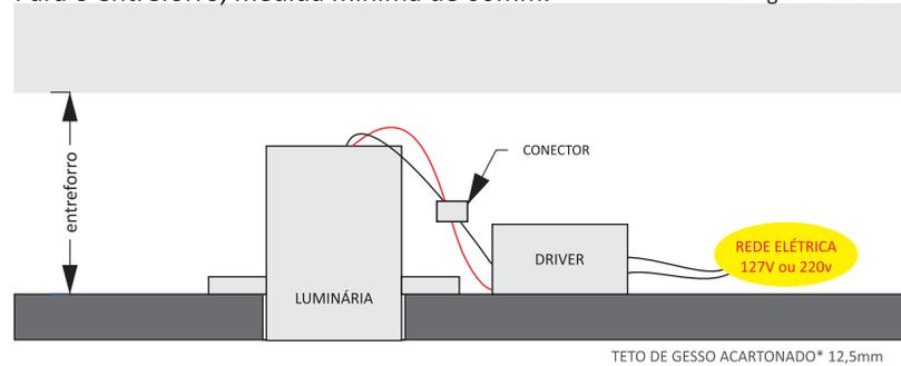
Faça instalações elétricas e conexões, deixando o driver no forro
