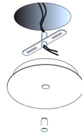
1. Desmonte o conjunto, girando a luva (d) até retirá-la do nipples (a).
