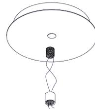
4. Coloque a canopla (c) atravessando o furo central da canopla (c) pelo nipples (a) e deixando aproximadamente 20mm do nipples (a) para fora.
