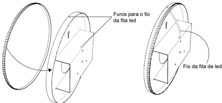
02. Passe o fio de alimentação pelo furo central e aparafuse a peça na parede pelos furos indicados.
