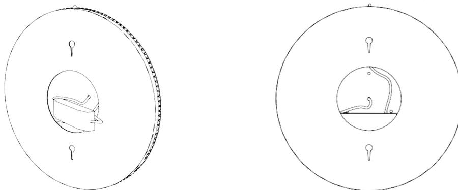
04. Encaixe a arandela no suporte da parede.
