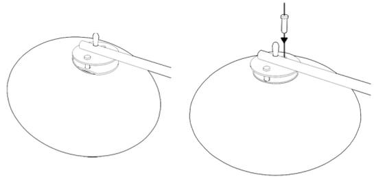
3) Fazer as ligações elétricas que já foram deixadas para a instalação da arandela. Parafusar com 2 parafusos com bucha cada haste da luminária.
