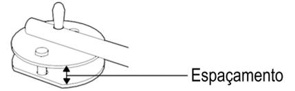
2) Utilize o espaçamento para encaixar o vidro e aparafuse o segundo parafuso.
