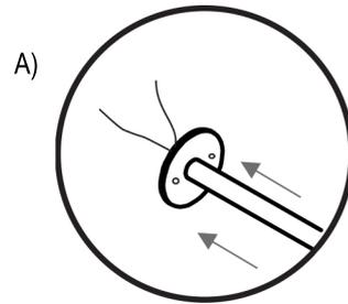
4) Depois de instalada, colocar as tampas das canplas com a fita adesiva enviada para tampar os parafusos.
