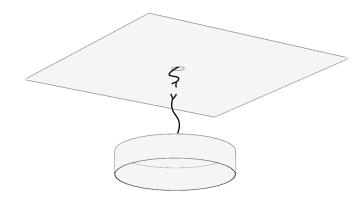
02. Aparafuse o fundo da luminária no teto com bucha e parafuso.
