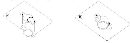
5. A) Gire a luminária 90°. B) Aparafuse de acordo com o gabarito. C) Coloque a lâmpada D) Encaixe o anel anti-ofuscante.
