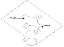
4. A) Puxe a fiação pelo corte e faça as ligações elétricas. B) Passe a fiação e luminária pelo corte.
