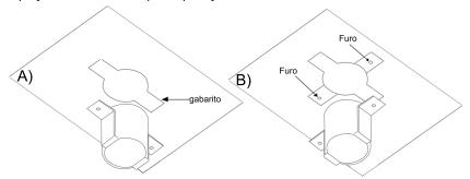
3. Recorte o gesso considerando APENAS duas abas do gabarito conforme o desenho a baixo. (Deixe marcado, sem cortar, as abas com a marcação dos furos)
