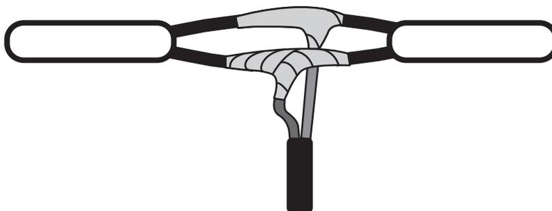
**Passo 3.** Proteja toda a emenda adequadamente com uma fita de autofusão, iniciando e terminando pelas capas externas dos cabos. Por fim, aplique uma camada de fita isolante com proteção UV.
