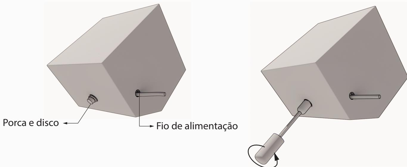
2. Retire a canopla com cuidado. Desprenda a borracha que fixa o vidro na canopla e efetue a troca da lâmpada.
