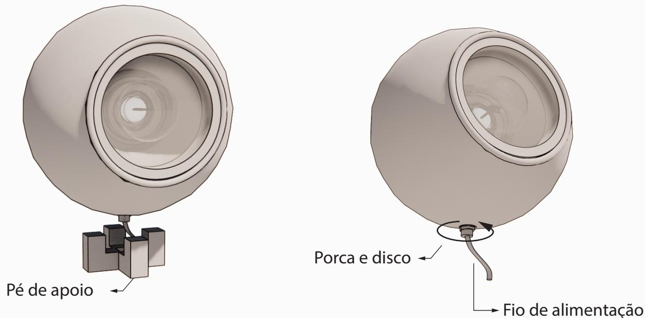
2. Retire a canopla com cuidado. Desprenda a borracha que fixa o vidro na canopla e efetue a troca da lâmpada.
