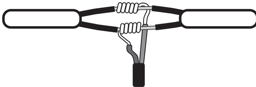
**Passo 2.** Aplique fita isolante em cada emenda separadamente. Em seguida, faça a ligação do produto à rede elétrica.
