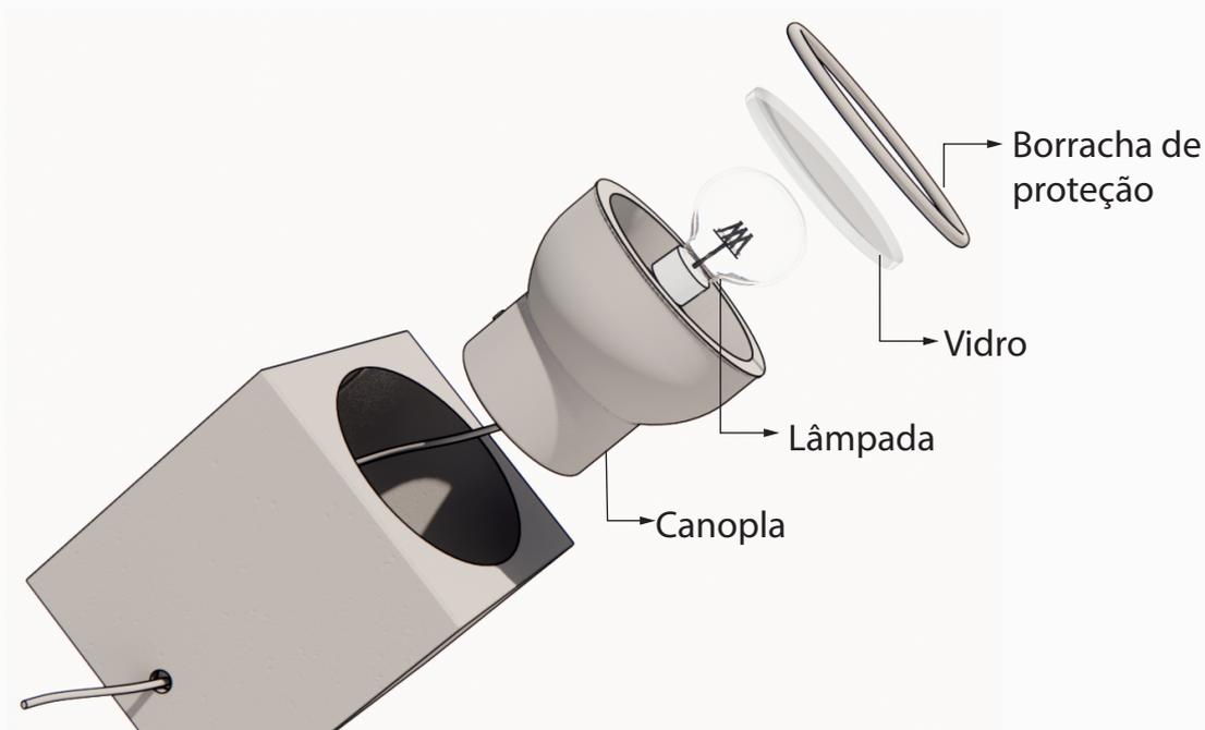
1. Retire o pé de apoio da luminária para ter acesso ao fio de alimentação. Remova a porca e o disco que fixam a canopla no corpo da luminária.
