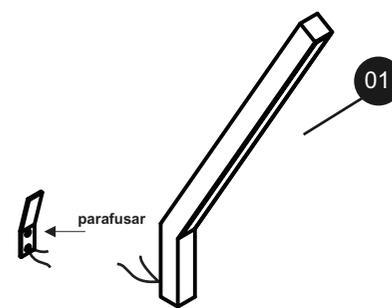
01. Parafusar a canopla na parede com a aba para cima.
