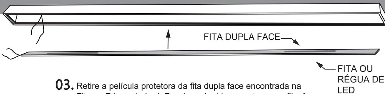
**03.** Retire a película protetora da fita dupla face encontrada na Fita ou Régua de Led. Encaixe o Led bem rente ao perfil e faça as conexões elétricas.
