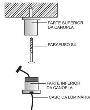
**03. AJUSTE DA ALTURA E INCLINAÇÃO DO PENDENTE**
